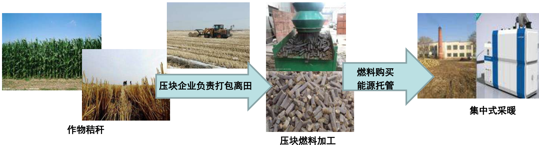
生物质锅炉改造的机关企事业单位取暖技术模式
