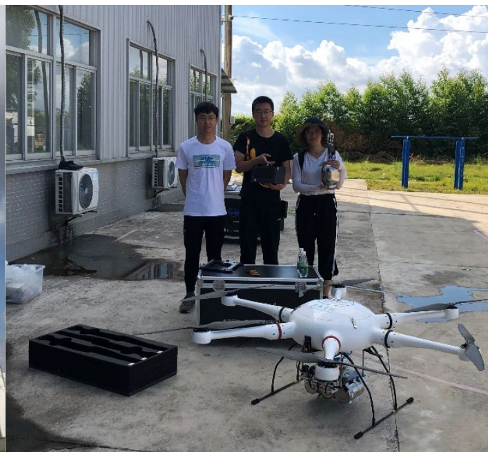
无人机环境检测仪与苏玛罐高空VOCs采样
