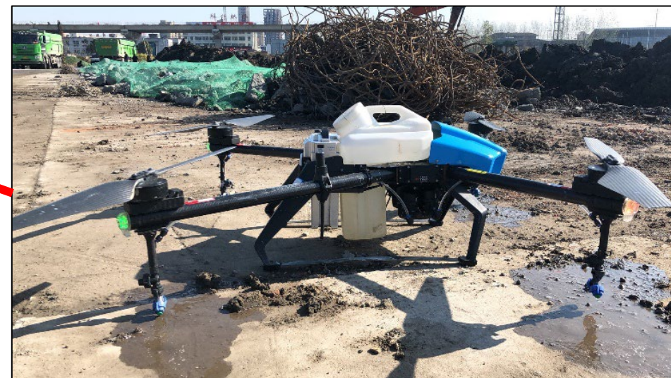
无人机喷洒大气污染物治理药剂
