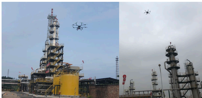
高空甲烷平面检测+甲烷垂直廓线检测
