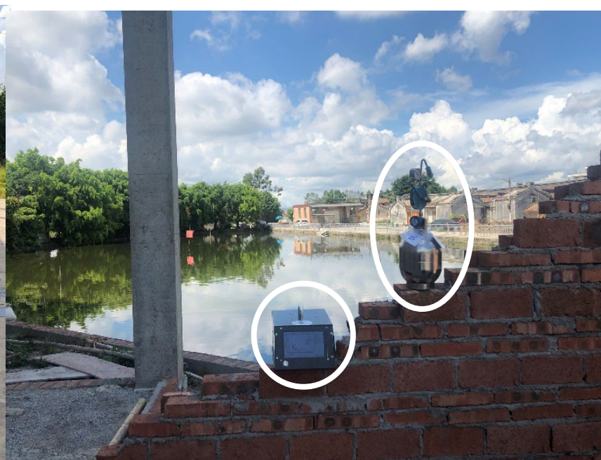
无人机环境检测仪与苏玛罐高空VOCs采样
