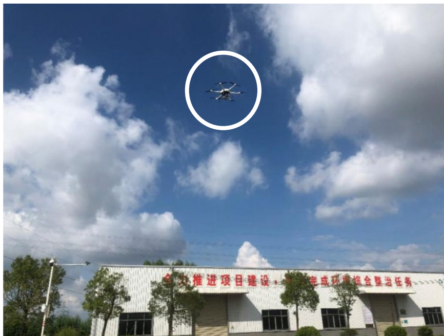
无人机高空苏玛罐VOCs采样
