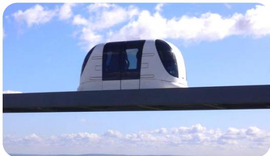
**1. 车辆:** 小, 全自动驾驶, 有空调, 电动车, 实现场地零排放。
